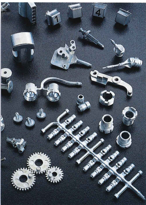
Exemples de pièces qui ont été produites par la 24NTX Musterteile auf einer 24NTX hergestellt
