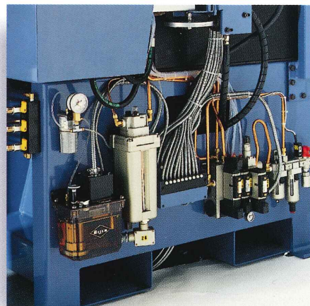
Système pneumatique avec lubrification du moule et des genouillères Pneumatisches System mit Schmierung von Form und Kniehebel
